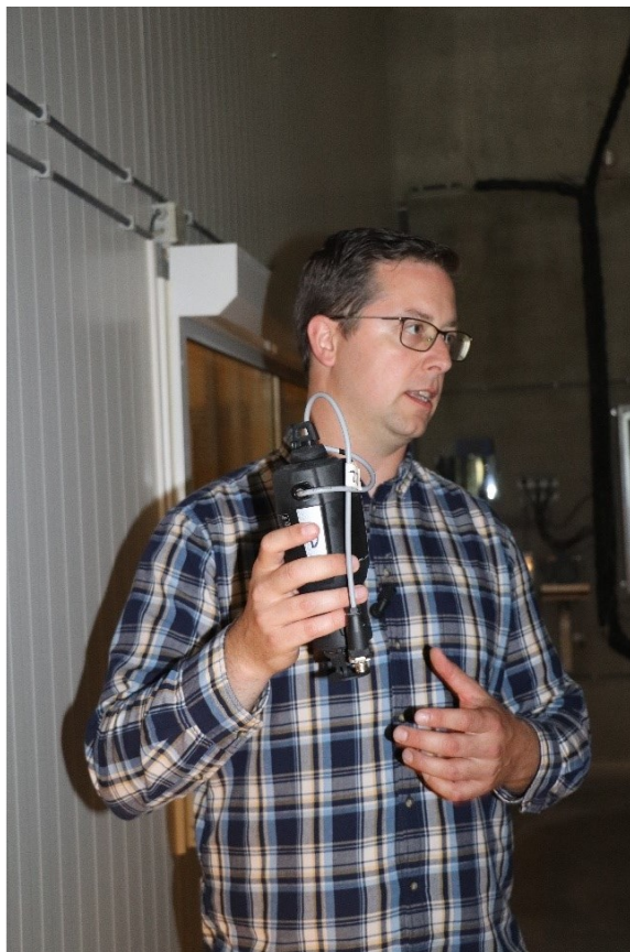
Foto 2: Mobiele ammoniaksensor (Dräger)
